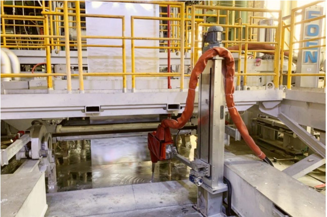
Kuva 2-4 Tecnar'in LIBS analysaattori tehdasympäristössä [8]
