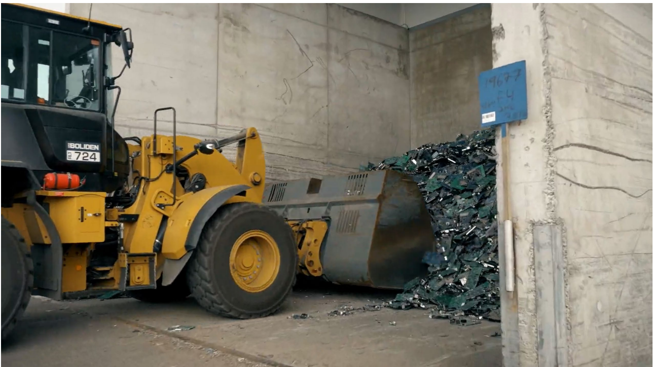
Kuva 4-2 Piirikorttijakeen käsittelyä Boliden Rönnskärin sulatolla [16]
