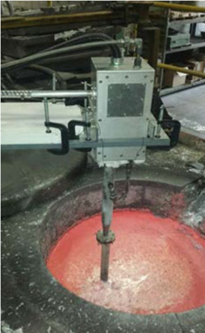
Kuva 2-5 ERCO:n OnSpec(R)-LIBS laitteisto mittaamassa sulaa alumiinia.
