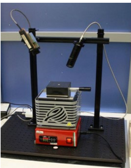
Kuva 3-1 Kuva SUMEA-asetelmasta, jossa näkyvät laser, keräysoptiikka ja uuni.
