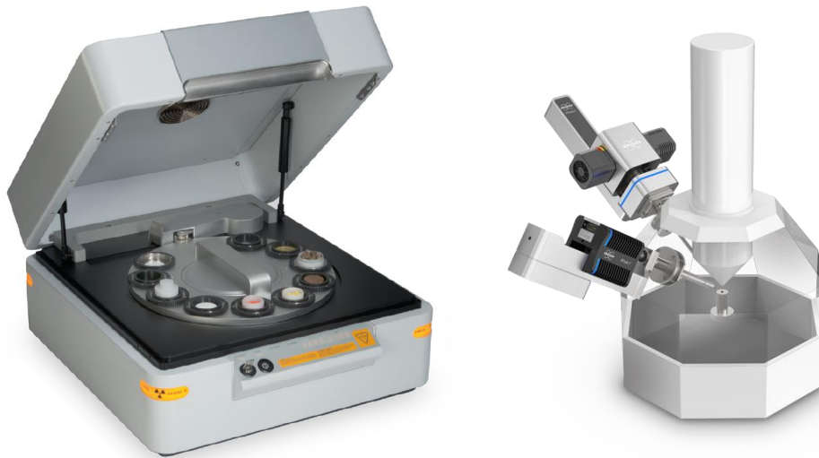
Kuva 3 Yllä olevissa kuvissa on esitetty Top Analytican laboratoriotasoiset XRF-mittalaitteet. Vasemmanpuoleisessa kuvassa on Malvern Panalytical Epsilon 3XL mittalaite ja oikeanpuoleisessa on havainnekuva XRF- ja EDS-mittaustavat yhdistävästä laitteesta. Tässä XRF ja EDS mittauspäät ovat Bruker Quantax Micro-XRF ja Bruker Nano XFlash 6/60 EDS.
