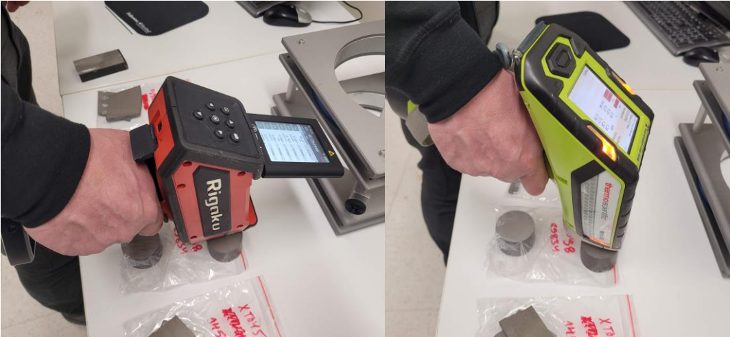
Kuva 1 Yllä on kuvattu kädessä pidettävät ja käytetyt mittalaitteet. Vasemmanpuoleisessa kuvassa on Rigakun KT-100 LIBS-menetelmään perustuva analysaattori ja oikeanpuoleisessa kuvassa on ThermoFisher Scientific:n Niton XL3t XRF-analysaattori.
