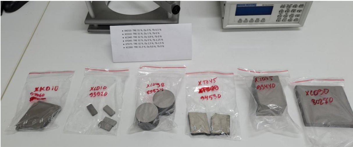
Kuva 4 Yllä olevassa kuvassa on esitetty NdFeB-magneettinäytteet. Näytteiden numerointi 1:stä 6:een menee oikealta vasemmalle.
