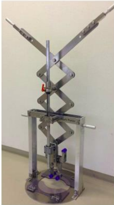
Kuva 26 Työkalu roottorin irrotusta varten (kannettava) [36]
