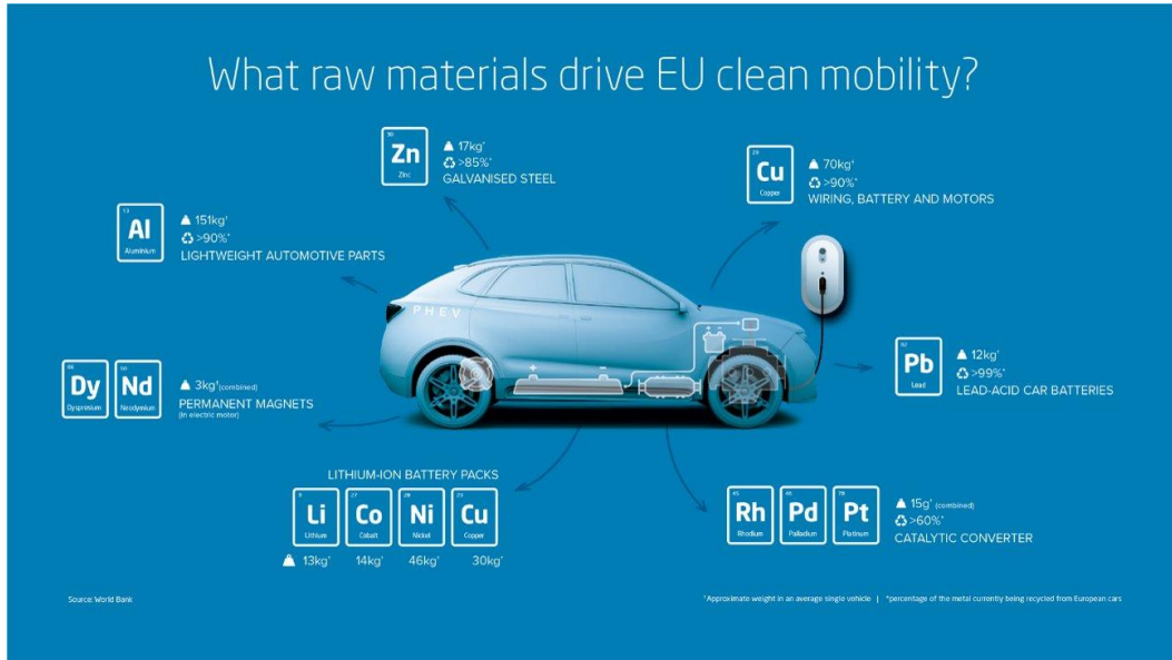
Kuva 73 Ladattavien hybridautojen sisältämät teknologiametallit ja niiden määrät [28]
