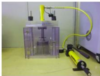
Kuva 27 Työkalu akselin irrotusta varten (kannettava) [36]
