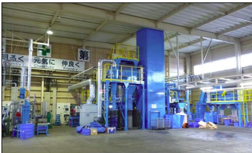
Kuva 30 Pilottilaitteet roottorin ja staattorin käsittelyä varten. NdFeB-magneettien lisäksi muita värimetalleja mm. kuparia ja alumiinia otetaan talteen. [37]
