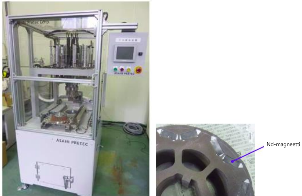
Kuva 29 a) Hydraulikkaan ja värinään perustuva magneettien irrotuslaite, b) roottoriin upotettu magneetti [36]
