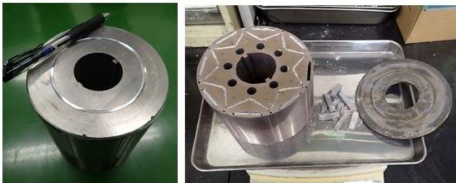
Kuva 88 Ajovoimamoottori ennen ja jälkeen demagnetisoinnin [32]
